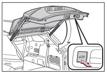
■ Closing the back door using the back door handle
